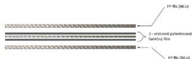
Obrázok 13: Schéma zloženia fólie DELTA®-PENTAXX / PLUS
